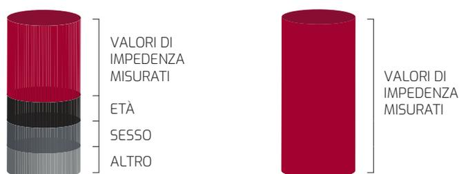
I parametri non vengono corretti in funzione del sesso e dell'età, ma sono calcolati **sola-mente in funzione dei valori di impedenza misurati dalla macchina**.
